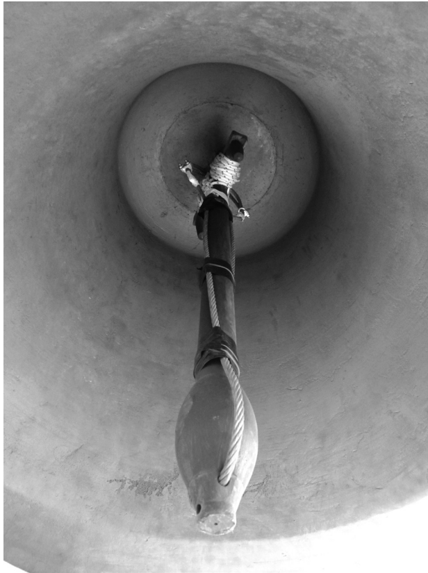
Fig. 11. Detall de l'interior de la campana Maria amb el batall —assegurat amb cable acerat— i la subjecció entre l'ansa batallera i el «soquet» (peça de fusta menuda) mitjançant corda de niló de gran resistència a l'abradió.
