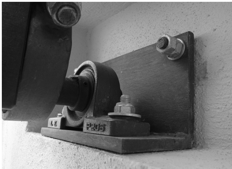
Fig. 64. Rodament mètric a boles d'una filera i untador de la campana Sants Abdó i Senén. Els eixos són barres estàndard de ferro negre colat, entre 30 i 60 mm, en funció de la grandària de la campana, i que queden incrustats dins de l'anell intern reforçat dels rodaments. Els suports dels coixinets queden ancorats a la fàbrica per mitjà de caragols amb una mètrica normalitzada i determinada 19 .
