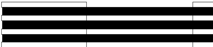
Fig. 43. Vista en planta de l'alineació correcta de tres corretges entre la roda i la corriola.
