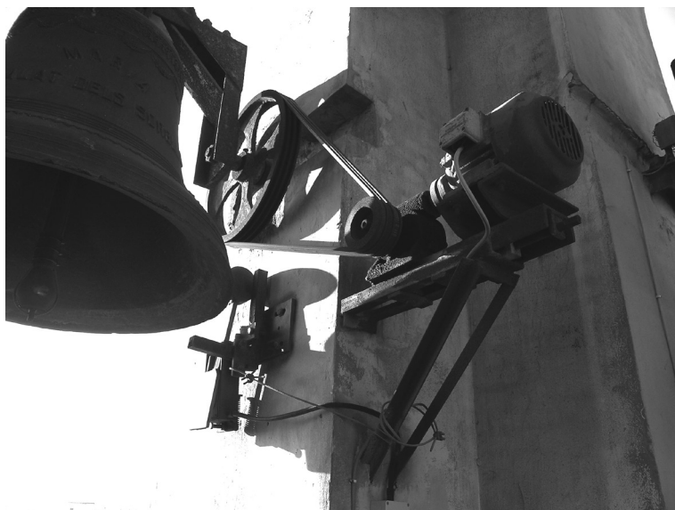
Fig. 46. Fotografia de l'any 2006 en què es pot veure el sistema de tracció electromecànica de la campana Maria. En la reductora s'observa que l'eix del motor va unit amb un maneguet de muntatge al caragol sense fi, el qual transmet el moviment giratori a un engranatge que hi ha davall seu perpendicularment i que comparteix eix amb la corriola motriu de triple gola, que va unida per mitjà de tres corretges trapezoidals a la roda conduïda de l'eix de la campana. El caragol que hi ha davall de la tapa deflector del motor i en l'extrem dret del perfil metàl·lic de la base del motor, era l'encarregat de tensar les corretges en augmentar o disminuir la distància entre els eixos de la corriola motriu i la roda conduïda acoblada a l'eix de la campana.
