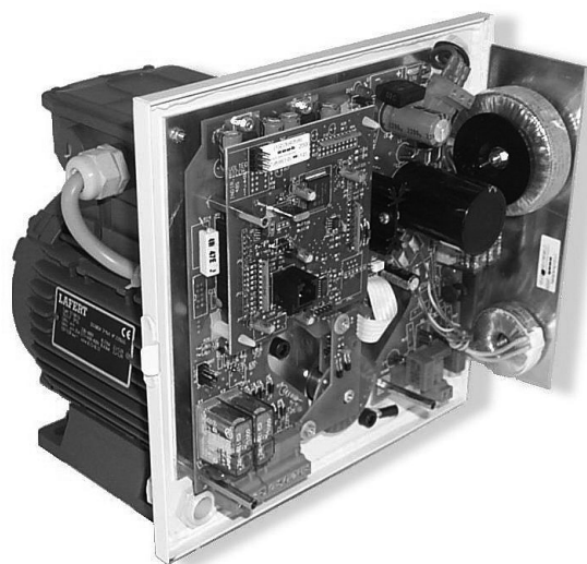
Fig. 67. Com podem comprovar a la fotografia adjunta d'un sistema Ecatron, cortesia de l'empresa 2001 Técnica y Artesanía SL, el ventilador del motor i la tapa deflectora s'han substituït per la caixa que conté el conjunt de dispositius electrònics, raó per la qual cosa se solen sobredimensionar els motors perquè no es calfen per sobrecàrrega, ja que no porten ventilació forçada.
